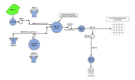
Figura 1 - Croqui do sistema de abastecimento de água do SAMAE - Fonte: Diagnóstico do Sistema de Abastecimento (CISPAR), 2018
